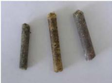
整體而言，廢棄物前處理做得越少，成本將越低，但是燃料效率也越低。反之，燃料等級隨數字越大而越高，因此RDF-7等級最高，而其能源效率也隨數字愈大而代表能源效率愈高。一般而言，RDF-1的能源效益小於15%，而RDF-7氣體燃料的效率則大於35%為最高。
