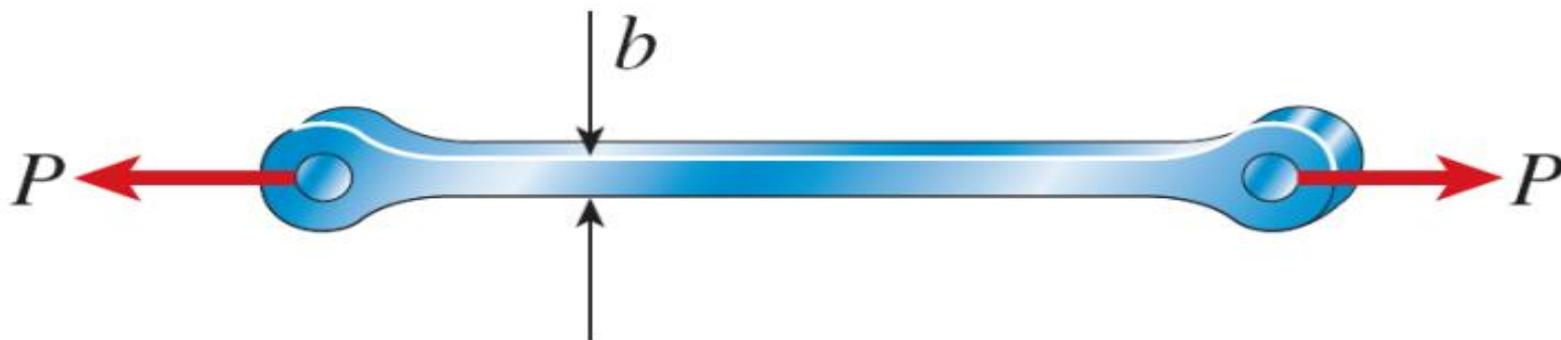
圖1-3 雙孔桿受到拉力載重 $P$ 的影響
